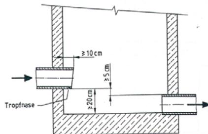
Bild 2: Kontrollschacht mit Mulde
